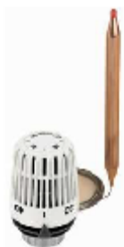
Heimeier thermostaat-kop K met een sonde die gevuld is met vloeistof (157 mm totale lengte, 11mm diameter) en 2 m capillaire buis. Instelbereik 10°C tot 40°C.
